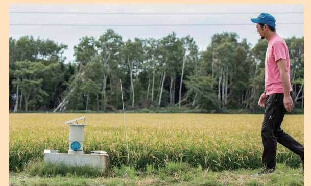
水位と水温を感知。スマートフォンでリアルタイムに確認が可能。
