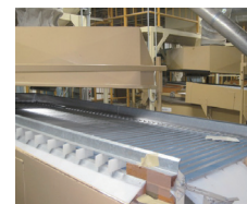
比重選別機 風と振動により、籾を比重毎に選別する
