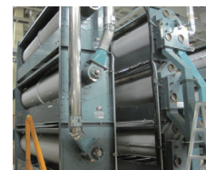
粒形分別機 長粒・短粒、異物などを除去する
